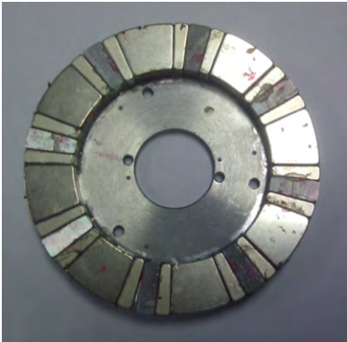
(b) 磁极组合型转子
